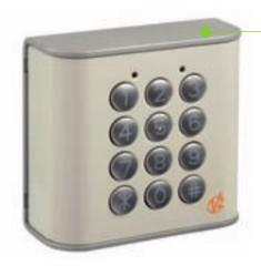
Il nuovo selettore digitale Sirmo-Digit via radio non richiede alcuna connessione elettrica e trasmette un codice compatibile con i trasmettitori della serie Phoenix a 433,92 MHz
